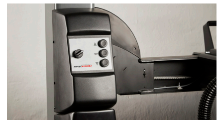
Pumpe og styring på forreste venstre søjle
